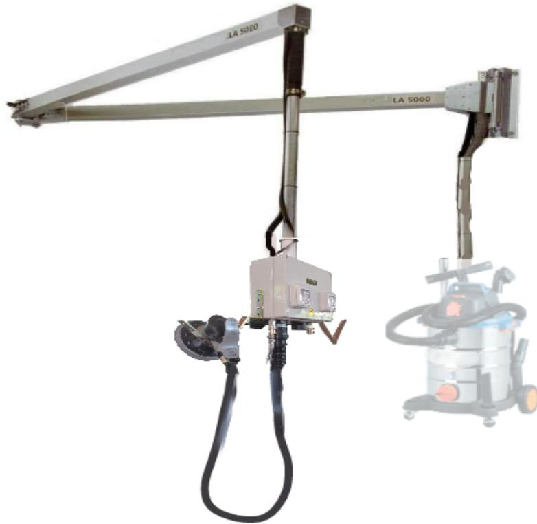
Le bras d'aspiration BA1 est la solution idéale pour les ateliers de menuiserie et les laboratoires du bois. Conçu pour éliminer efficacement la poussière de ponçage, il améliore la qualité de l'air, protège la santé des opérateurs et assure le respect des normes en vigueur.
